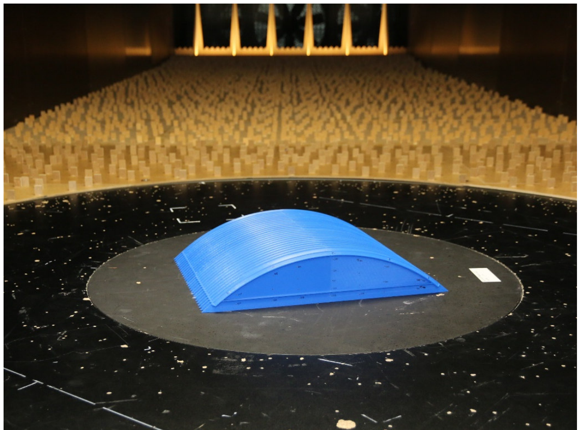
Abb. 2.4: Windkanalmodell der Paketposthalle im Grenzschichtwindkanal; Konfiguration 1: „Solitär“; Geometrischer Modellmaßstab: 1:350
