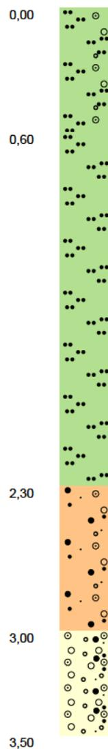
0,60 Schluff, kiesig bis schwach kiesig, schwach sandig, Auffüllung, dunkelbraun, schwach feucht, < 1 Vol.-% Ziegelbruchstücke, leicht zu bohren, Geruch: leicht muffig
