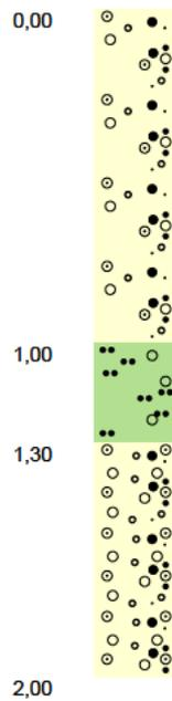
1,00 Kies, stark sandig, schwach schluffig, Auffüllung, hellbraun, schwach feucht, ca. 1 Vol.-% Ziegelbruchstücke, Geruch: o.b.W.
